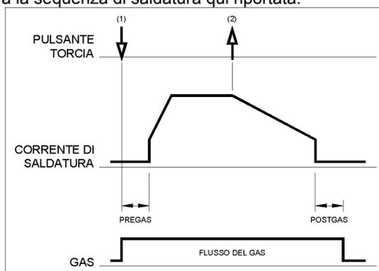
1. Premere e tenere premuto il pulsante della torcia TIG per iniziare la sequenza. La macchina apre la valvola del gas per avviare il flusso del gas protettivo. Dopo il tempo di pregas, che elimina l'aria dal tubo torcia, si attiva l'uscita macchina. A questo punto scocca l'arco nel modo di saldatura selezionato. Una volta scoccato l'arco la corrente in uscita viene aumentata con una rampa o tempo di salita controllato fino a quando il valore della corrente di saldatura è raggiunto.
