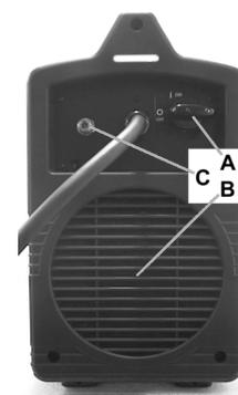
Unità di raffreddamento Coolarc 20 collegata a una macchina "V2###-T / -TP": l'accensione / spegnimento dell'unità Coolarc 20 segue il funzionamento della ventola della saldatrice. Se è selezionata la saldatura con elettrodo manuale (MMA) l'unità Coolarc 20 rimane spenta.
