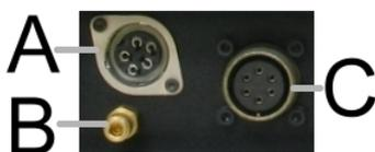
fornitura è compreso un ulteriore attacco gas adatto al collegamento sul davanti della macchina, se necessario. Collegare poi l'attacco sul retro della macchina al regolatore di flusso sulla bombola gas da usare. Nell'imballo sono pure compresi un tubo per il gas in arrivo con i relativi attacchi. Collegare il pulsante della torcia TIG al connettore pulsante (A) sul davanti della macchina.
