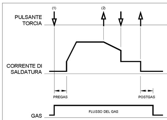
Come mostrato qui sopra, durante il tempo di discesa è possibile premere di nuovo il pulsante e tenerlo premuto per interrompere la funzione di rampa di discesa e mantenere la corrente in uscita al valore di Cratere. Al momento in cui si rilascia il pulsante l'uscita viene spenta e parte il tempo di postgas. L'operazione, 2 tempi con riavvio disabilitato, è l'impostazione di default.
