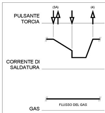
Come indicato qui, quando si sia premuto e rilasciato rapidamente il pulsante torcia TIG come visto al Tempo 3A, si può, una seconda volta, premerlo e rilasciarlo rapidamente per terminare il tempo di discesa e arrestare la saldatura.
