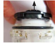
6. Ruotare delicatamente gli elementi di tenuta neri ❶ fino a che si separano ed è possibile rimuovere da questi l'elemento filtrante dell'aria sporco ❷.
