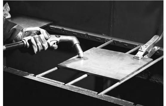
2. Accendere la torcia mentre forma un angolo con la lamiera. Ruotare lentamente la torcia a una posizione perpendicolare (90°).
