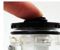
**Installare l'elemento filtrante dell'aria (per bicchierini con protezione di metallo)**
