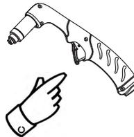
Verificare che il grilletto non sia danneggiato. Verificare che il corpo torcia non presenti crepe e fili scoperti. Sostituire qualsiasi componente danneggiato.
